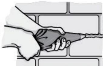
Para el junteador prepara una mezcla espesa. SIEMPRE utiliza una dulla (adquiérela con tu distribuidor de Perdura Stone®) y aplícala uniformemente cuidando que no escurra.
