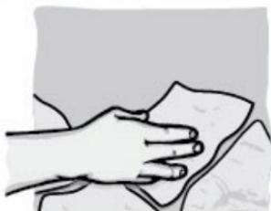
Limpia la pieza del polvo y coloca el adhesivo "Pega Piedra" en todo el reverso de la piedra a colocar de manera uniforme. Presiona la pieza asegurando que se sujete bien el adhesivo a la superficie.
