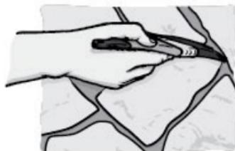
Retira el exceso de junteador con el mango de una brocha y con las cerdas de la misma brocha detállalo.
